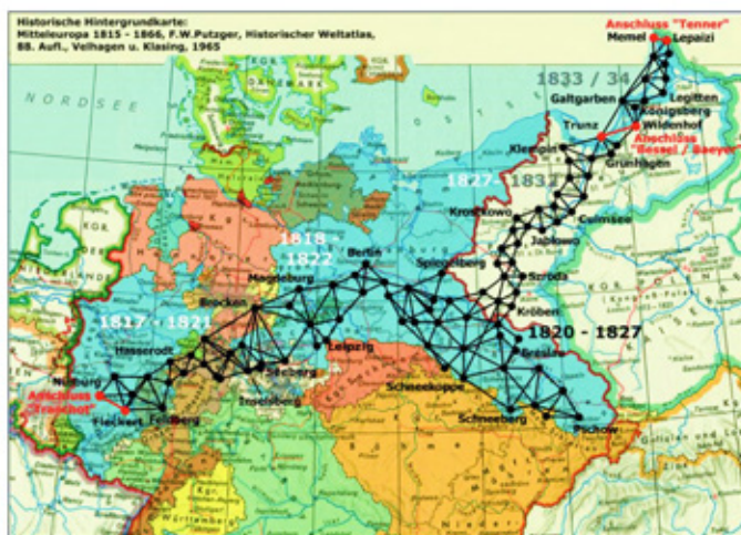
Rys.1. Łańcuchy triangulacyjne pruskiego sztabu generalnego od Renu przez Śląsk do Prus Wschodnich z lat 1817-1834 [20]
