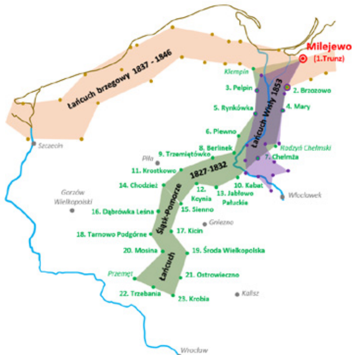
Rys. 2. Zbiorcze zestawienie najstarszych łańcuchów pruskich pomierzonych w latach 1827-1853 (wprowadzono polskie nazwy punktów, numery punktów według tabeli 1 - opracowanie własne)
